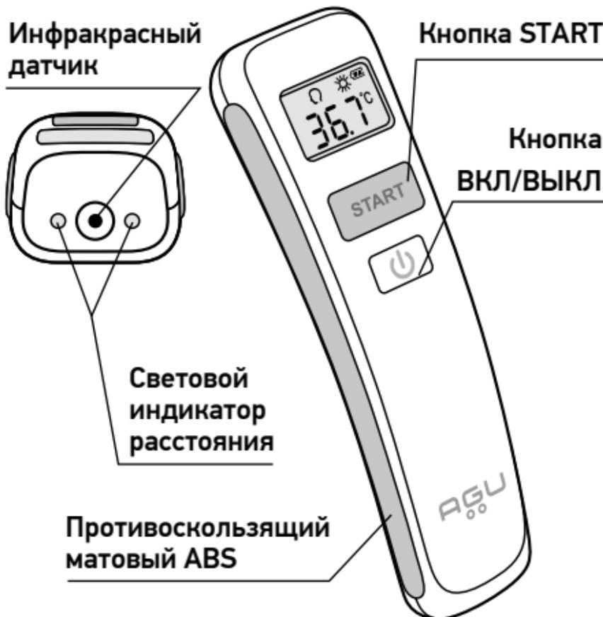
Особенности термометра инфракрасного цифрового бесконтактного **AGU NC8A**:
