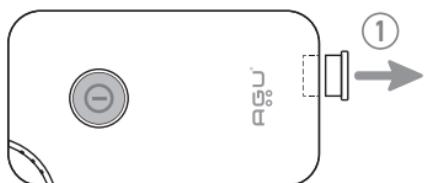
1 Снимите крышку воздушного фильтра, осторожно потянув ее.
