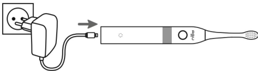
Die Ladeanzeige blinkt während die Hauptbürsteneinheit geladen wird. Wenn die Haupteinheit der Zahnbürste vollständig aufgeladen ist, erlischt das Leuchten . Eine komplette Ladung dauert typischerweise bis zu 2 Stunden.
