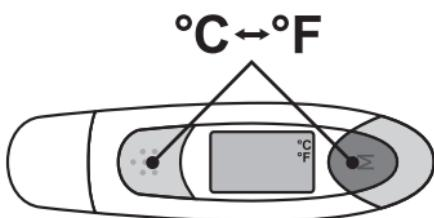
Ce thermomètre peut indiquer la température en Fahrenheit ( $^{\circ}\text{F}$ ) ou en Celsius ( $^{\circ}\text{C}$ ).
