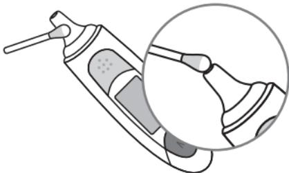
После процедуры очистки поверхность линзы должна быть зеркально чистой. Поскольку при испарении дезинфицирующего раствора поверхность линзы охлаждается, следует выдержать термометр несколько минут при комнатной температуре перед использованием после очистки.
