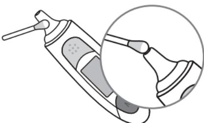
Nach der Reinigung soll die Oberfläche der Linse spiegelhell sein. Da sich bei der Verdampfung des Desinfektionsmittels die Oberfläche der Linse abkühlt, ist das Infrarot Thermometer für Kinder nach der Reinigung vor der Benutzung innerhalb von einigen Minuten bei Raumtemperatur zu halten.
