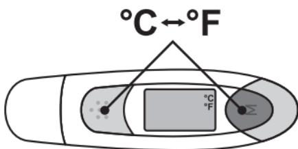
Die Temperatur kann sowohl in Celsius Grad ( $^{\circ}\text{C}$ ), als auch in Fahrenheit ( $^{\circ}\text{F}$ ) gemessen werden.
